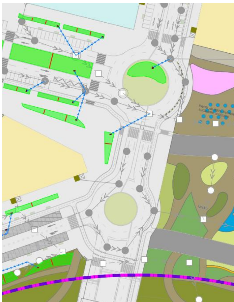
Figura 21. Aplicación de SUDS en Zona 5.
