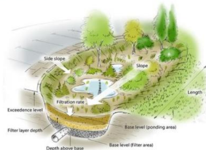
Figura 23. Ejemplo de interfaz de introducción de parámetros de diseño de un área de biorretención en InfoDrainage.
