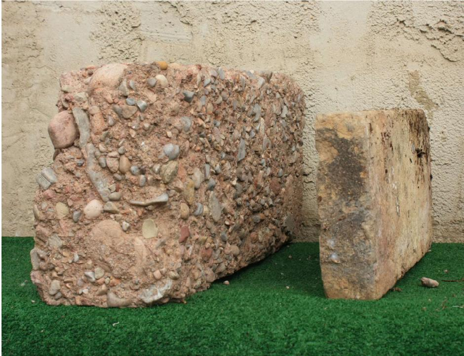
Figura 98. Bloque de Hormigón y ladrillo manual. (Pastor, R. 2010)
