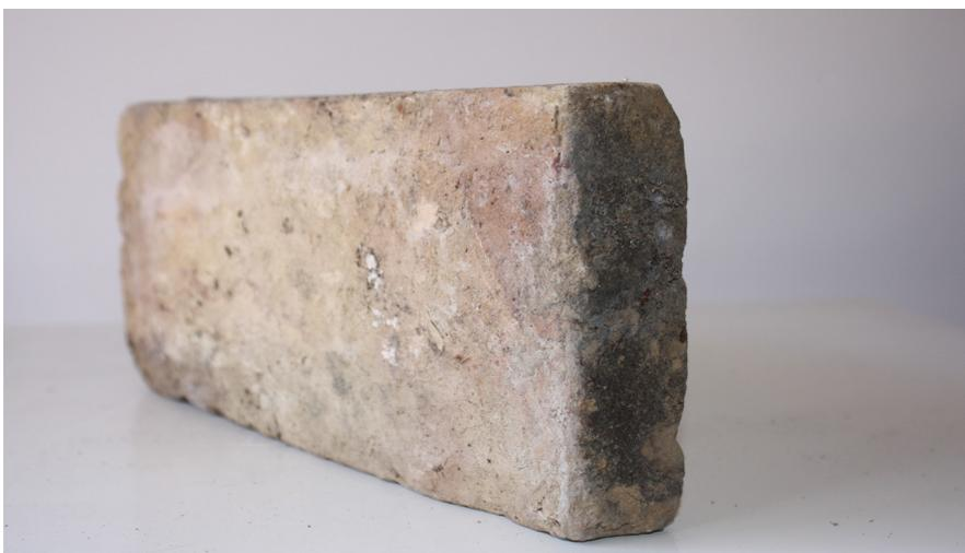
Figuras 225. Ladrillo manual para revestir. (Pastor, R. 2009)
